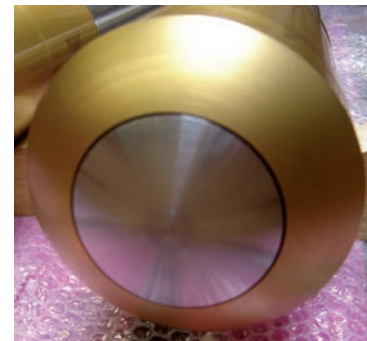
Плунжерный диск с покрытием из карбида вольфрама
